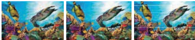
Niewłaściwe rozmieszczenie kropli przy druku dwukierunkowym
